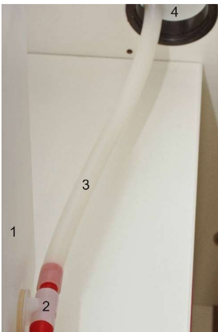
Рис. 5: 1. Канистра 2. Кран 3. Шланг 4. Отвод воды в фильтр
